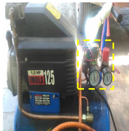
Gambar 6. Pengujian Sensor Tekanan Udara Menggunakan Lampu Indikator Dengan Batas Minimum 5 bar
