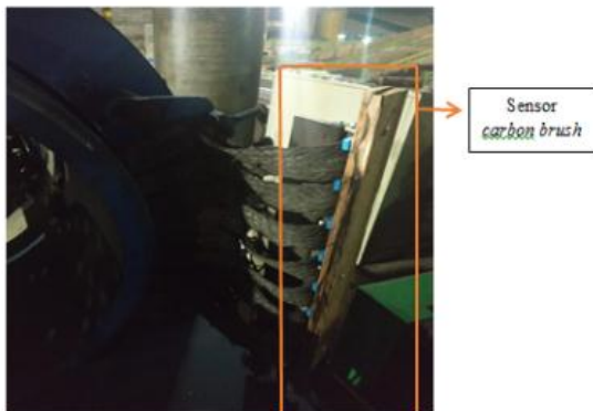
Gambar 10. pengujian sensor dengan panas carbon brush
