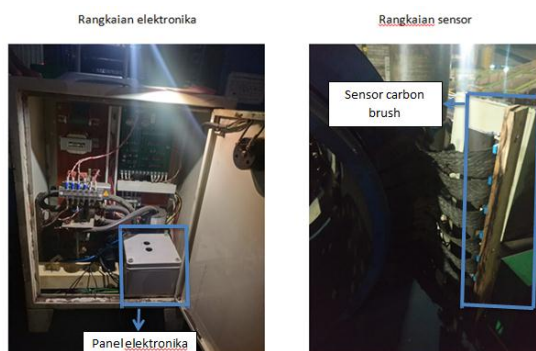
Gambar 2. Mekanik alat sensor carbon brush rangkaian elektronika dan rangkaian sensor
