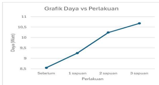
Gambar 6. Grafik nilai rata-rata daya untuk kondisi kotoran daun
