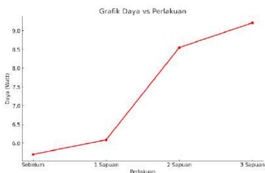
Gambar 3. Grafik daya pada pukul 08.00 untuk kondisi kotoran daun
