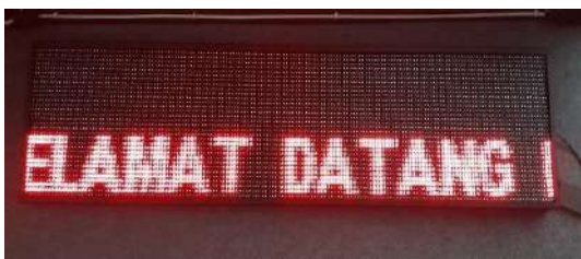
Gambar 9. Pengujian Tampilan Running Teks
