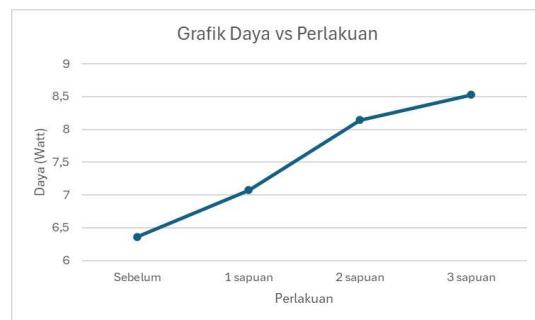
Gambar 5. Grafik daya pada pukul 08.00 untuk kondisi kotoran daun
