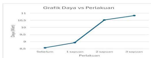
Gambar 4. Grafik nilai rata-rata daya untuk kondisi kotoran daun
