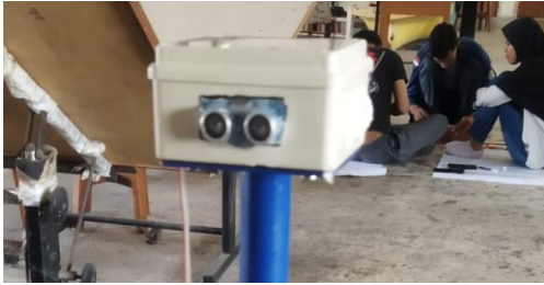
Gambar 3. Sensor ultrasonik yang digunakan
