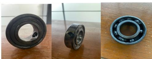
Gambar 3. Rekondisi bearing uji
