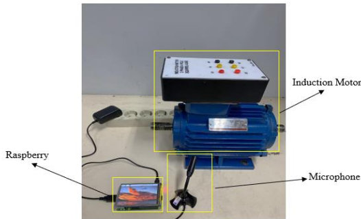
Gambar 1. Konfiguasi sistem monitoring kerusakan bearing
