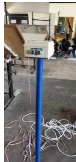
Gambar 6. Pengujian pendeteksian jarak atau ketinggian
