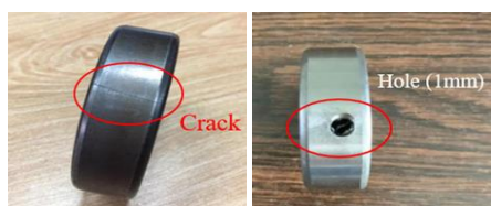
Gambar 4. Rekontruksi outer race bearing
