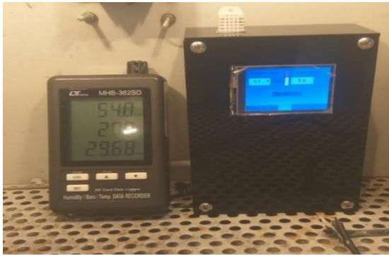
Gambar 13. Pengujian DHT 22 suhu dan Kelembaban
