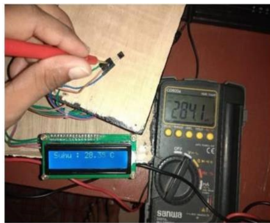
Gambar 5. Hasil pengukuran tegangan sensor LM35
