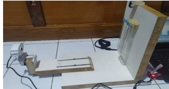
Gambar 6. Hasil Rancang Bangun Alat Uji Kualitas Density BBM (tampak samping)
