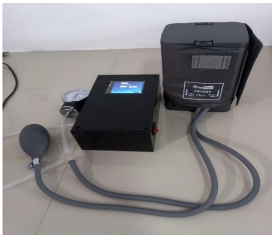
Gambar 14. Instalasi kalibrasi Tensimeter
