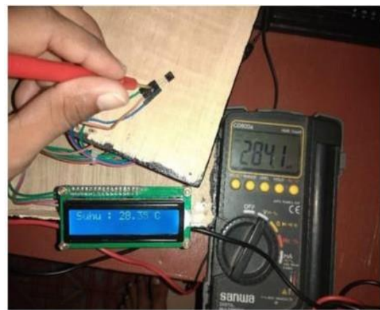
Gambar 5. Hasil pengukuran tegangan sensor LM35
