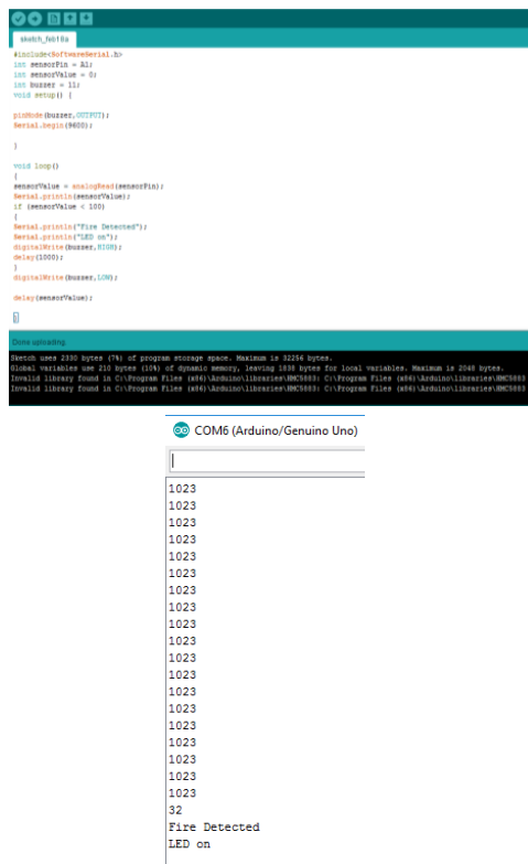
Gambar 15. Pengujian Respon Flamsensor
