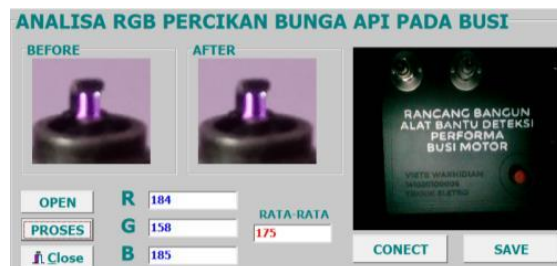
Gambar 9. Tampilan Software Pengujian Nilai RGB Bunga Api Busi
