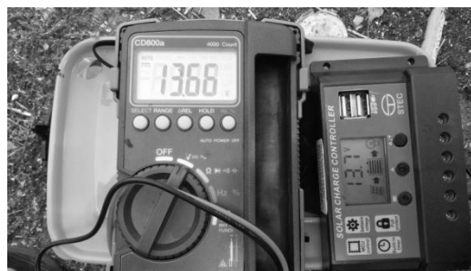
Gambar 3. Tegangan Masuk Pada Panel Surya
