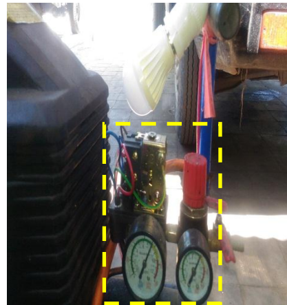
Gambar 5. Pengujian Sensor Tekanan Udara Menggunakan Lampu Indikator Dengan Batas Maksimum 8 bar
