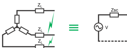
Gambar 3. Gangguan hubung singkat 3 fasa
