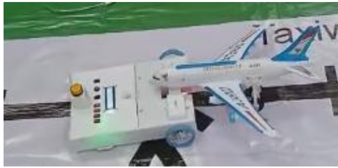
Gambar 10. Posisi Akhir Dari Robot Setelah Mendorong Pesawat Dari Apron 3 Menuju Taxiway Arah Kiri
