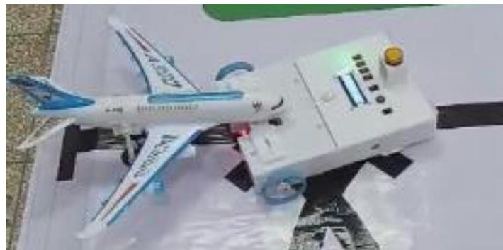
Gambar 11. Posisi Akhir Dari Robot Setelah Mendorong Pesawat Dari Apron 4 Menuju Taxiway Arah Kanan
