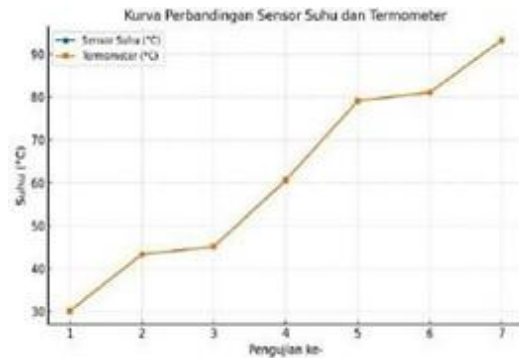
Gambar 7. Kalibrasi Sensor Suhu dengan Thermo Meter
