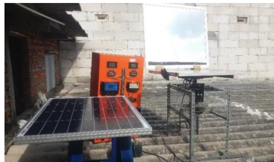
Gambar 6. Rangkaian keseluruhan pada sistem reflector panel surya
