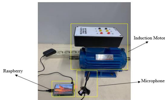
Gambar 1. Konfiguasi sistem monitoring kerusakan bearing
