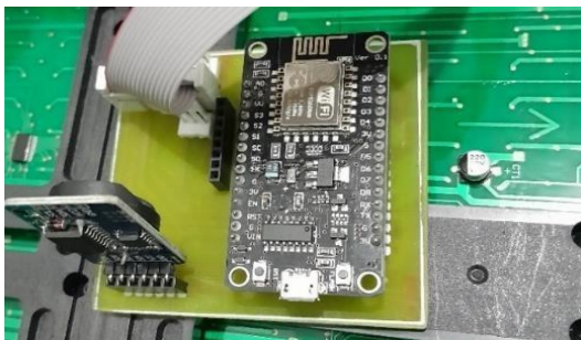
Gambar 5. Hardware NodeMCU ESP 8266 dan RTC DS3231
