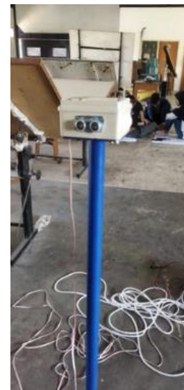
Gambar 6. Pengujian pendeteksian jarak atau ketinggian
