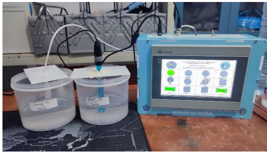
Gambar 7. Pengujian Sensor TDS dan pH
