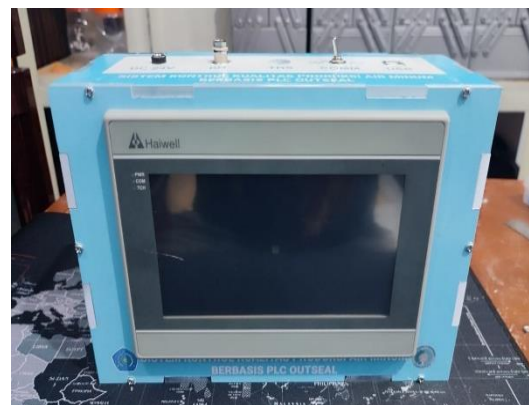
Gambar 6. Sistem Kontrol Kualitas Produksi Air Minum Berbasis PLC Outseal
